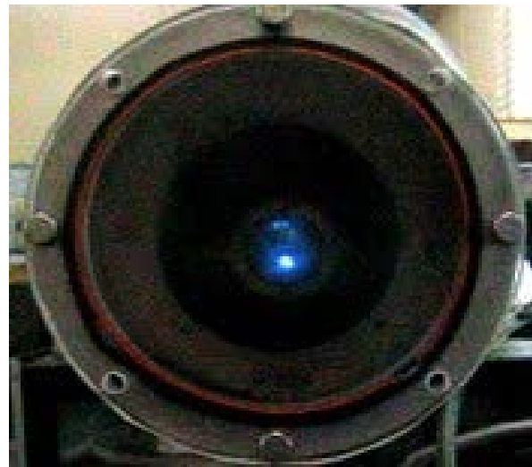
Gambar 7. Spot plasma dalam BE pada kevakuman 6,8 \times 10^{-3} Torr dan tegangan 10 kV.
