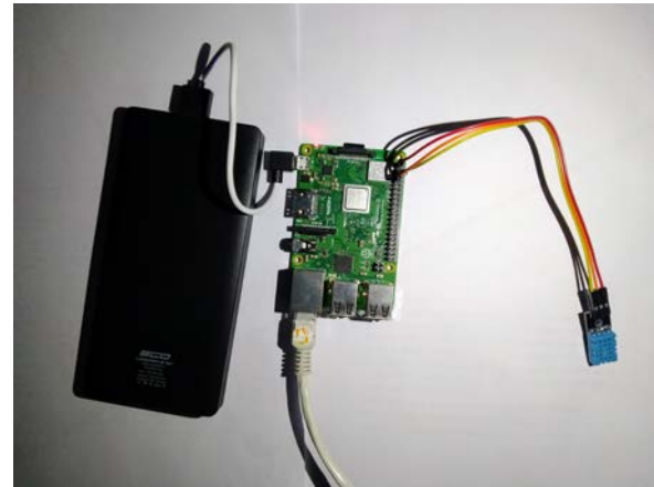
Gambar 3. Rangkaian alat Raspberry Pi dengan sensor DHT11
